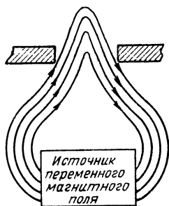
Рис. 2.13. Прохождение магнитного потока через отверстие.
