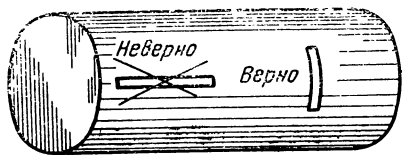
Рис. 2.25. Расположение щелей для вывода проводов из экранированной катушки.
